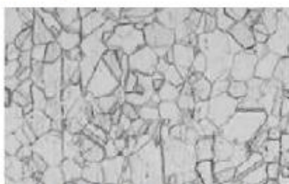
Grado 316 L. Microestructura típica, 200X. Ataque químico con
