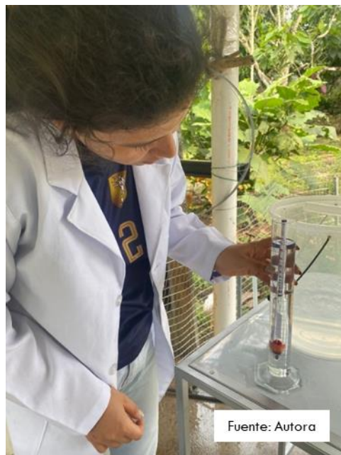
Medición del grado alcohólico de 1 º R
