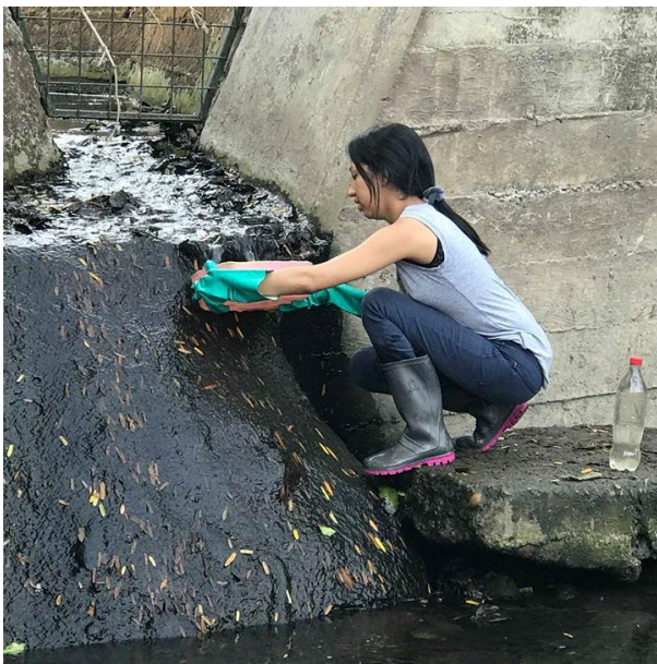
Anexo 5. Realización del aforo volumétrico en la descarga 2.
