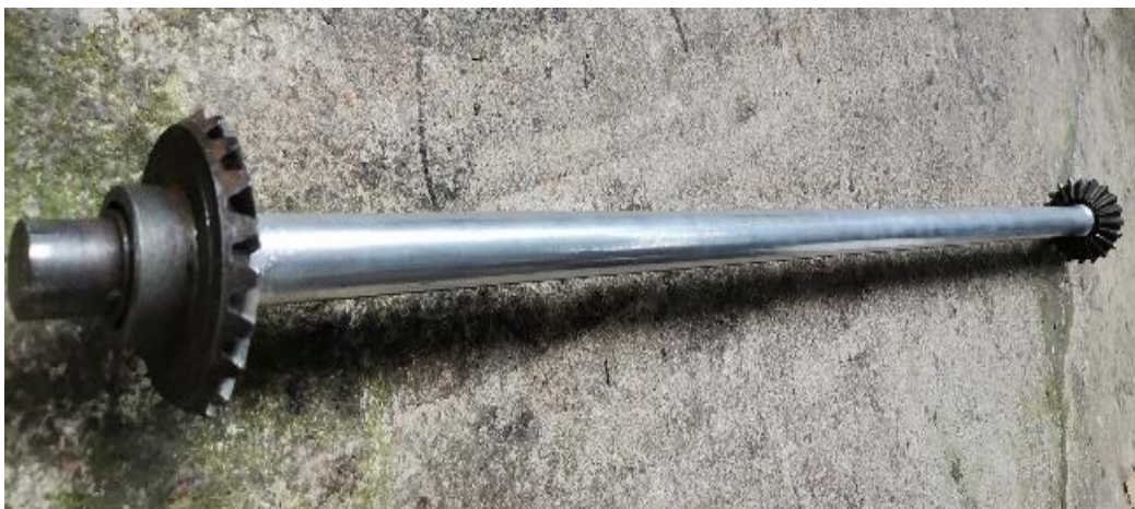
Figura 92. Eje de transmisión de la máquina de velas.
