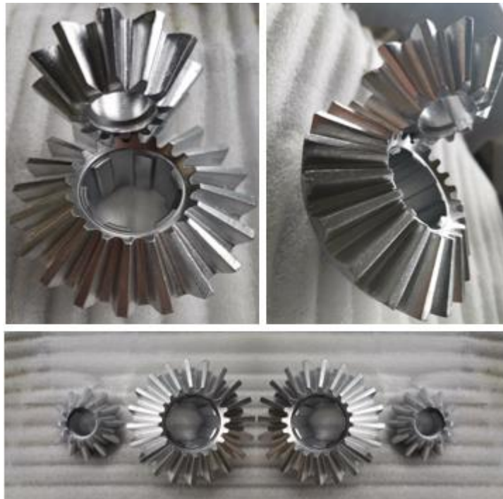
Figura 91. Engranajes cónicos rectos fabricados.
