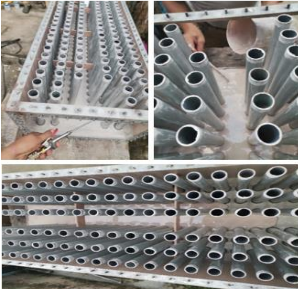
Figura 79. Colocación de la mezcla de resina y masilla plástica parte interior.
