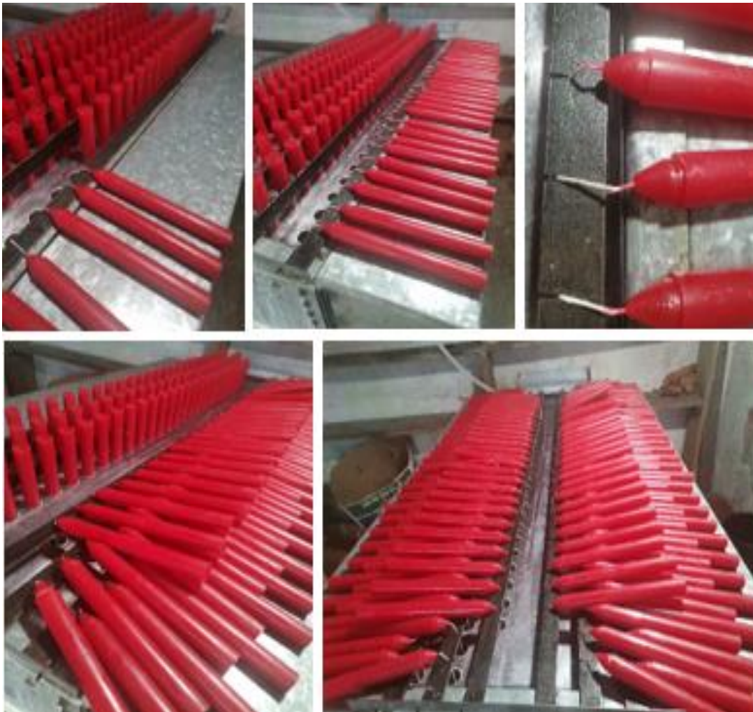
Figura 126. Extracción y corte de las tiras de parafina que contiene la vela.
