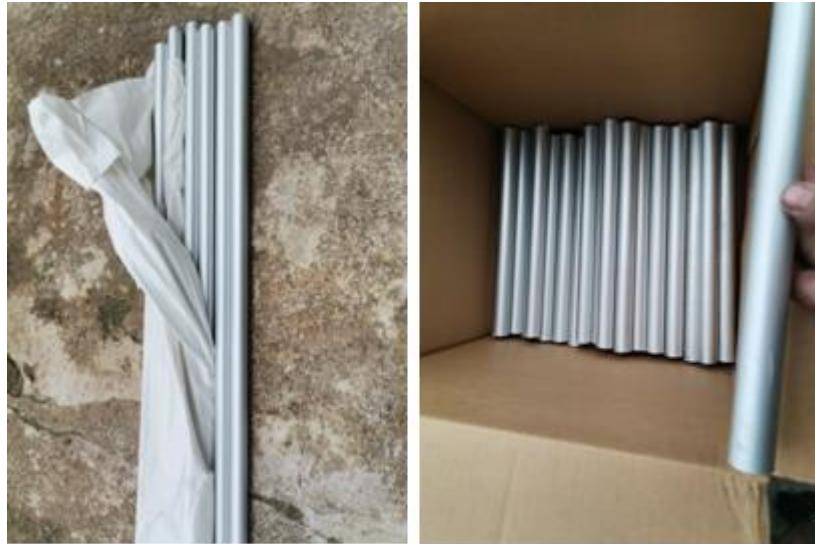
Figura 72. Corte de los tubos de aluminio para el banco de tubos.
