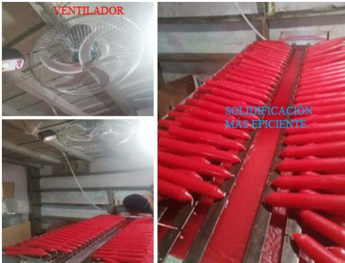
Figura 127. Colocación de ventilador en la parte superior de la máquina.
