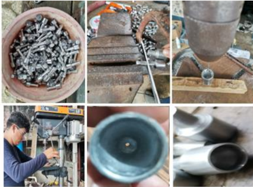
Figura 86. Proceso de preparación de la copa, lijado, perforado y cortado.
