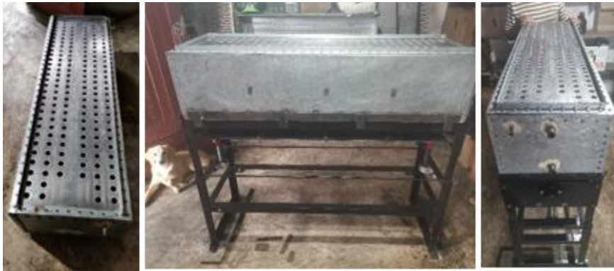
Figura 111. Colocación de banco de tubos en la estructura.
