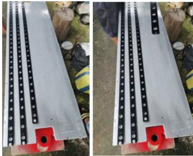
Figura 99. Colocación de las platinas guía expulsores.
