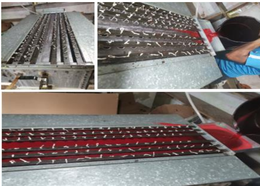
Figura 120. Vertido de la parafina líquida.
