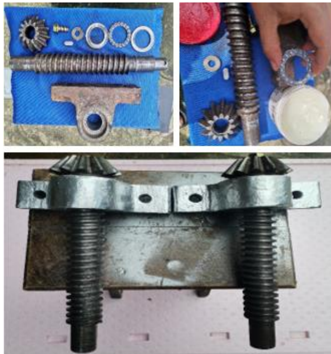
Figura 100. Colocación del soporte principal en tornillo de potencia y piñón.
