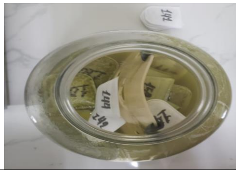
Anexos 27. Introducción de las muestras en los frascos de la incubadora DAISY
