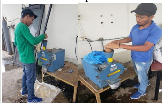
Anexos 18. Molido de los subproductos en un molino pulverizador
