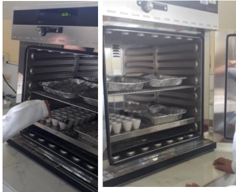
Anexos 19. Secado de las Bolsistas ANKOM F57 en la estufa
