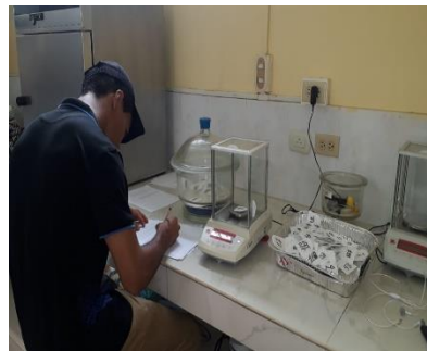
Anexos 20. Toma de dato del pesos de la bolsitas ANKOM F57
