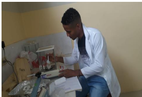
Anexos 21. Pesado, llenado y sellado de las bolsitas ANKOM F57 con los subproductos
