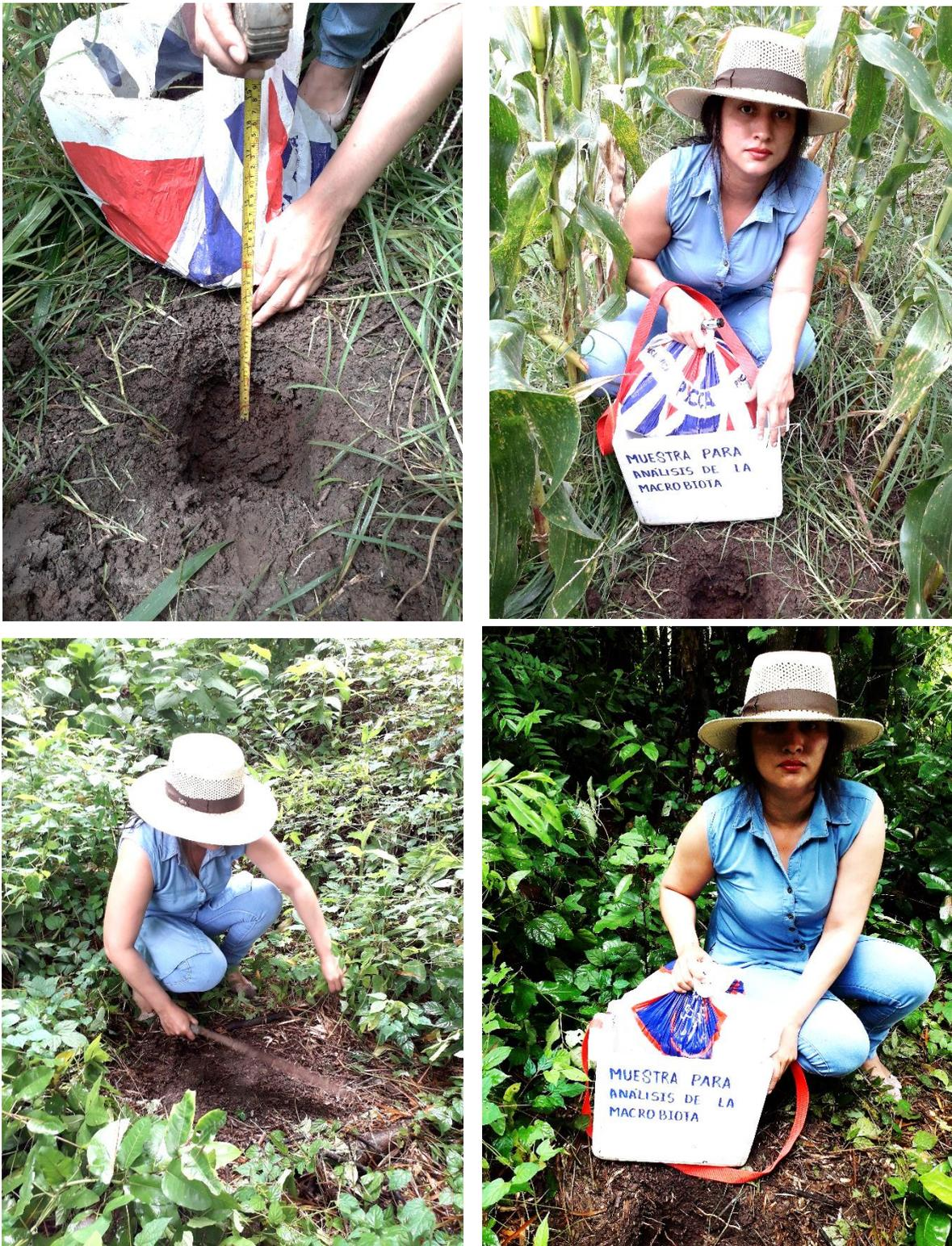
**Figura 4.** Toma de muestras de suelo dentro y fuera del cultivo de maíz, para análisis de la macrobiota en el humedal Abras de Mantequilla, cantón Vinges.
