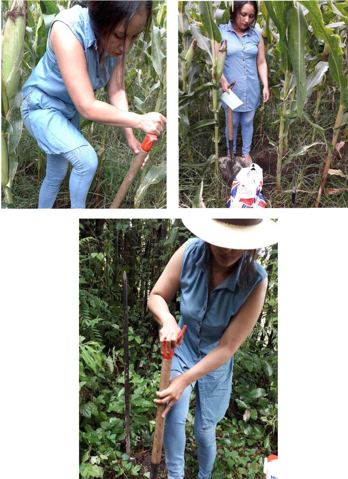
**Figura 3.** Toma de muestras de suelo dentro y fuera del cultivo de maíz, para análisis físico-químico en el humedal Abras de Mantequilla, cantón Vinces.
