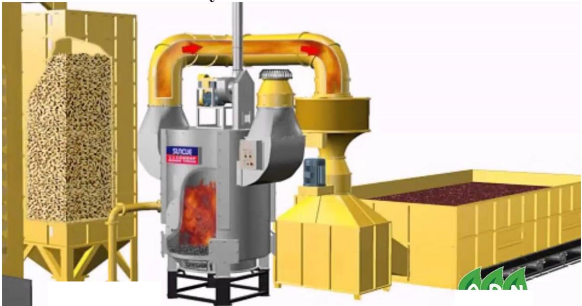
Figura 5. Secadora horizontal de flujo continuo
