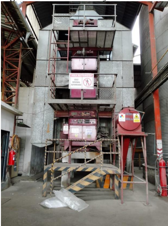
Figura 4. Secadora de flujo continuo vertical o tipo torre
