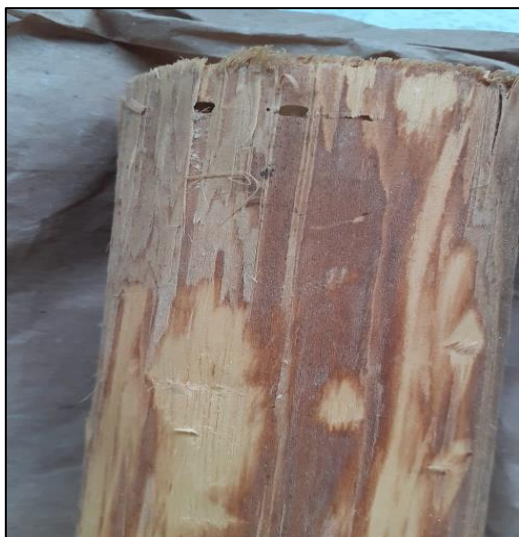
Identificación de galerías producidas por los escolitinos
