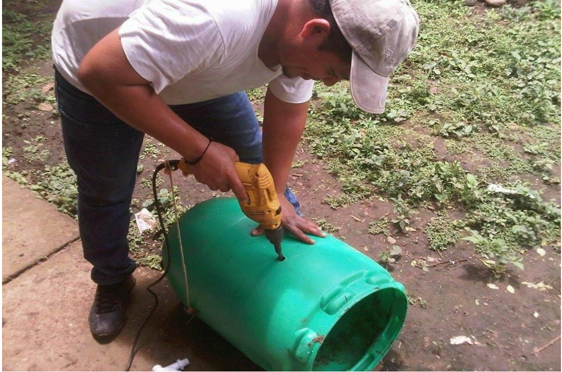
Figura 2. Elaboración de los biodigestores (orificio para llave de paso)
