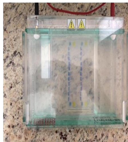
d.) Programar la cámara a 100 voltios una vez introducido el ADN en el gel.
