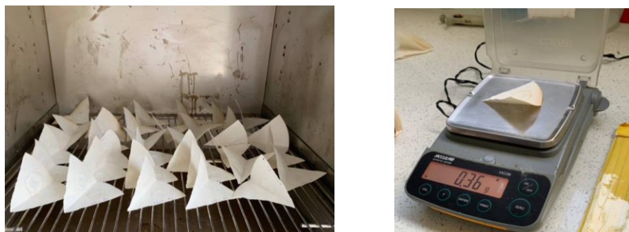
Secado del papel filtro húmedo en estufa y registro del peso del papel filtro seco en una balanza analítica.
