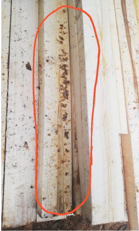
Anexo 10. Defecto del corazón interior >50%
