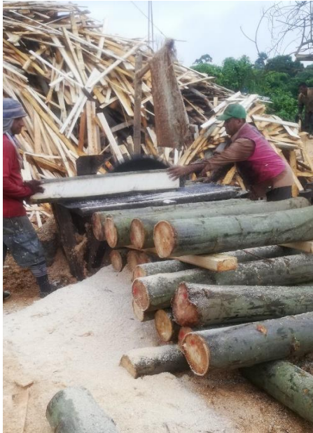
Anexo 1. Proceso de aserramiento de los tucos de madera
