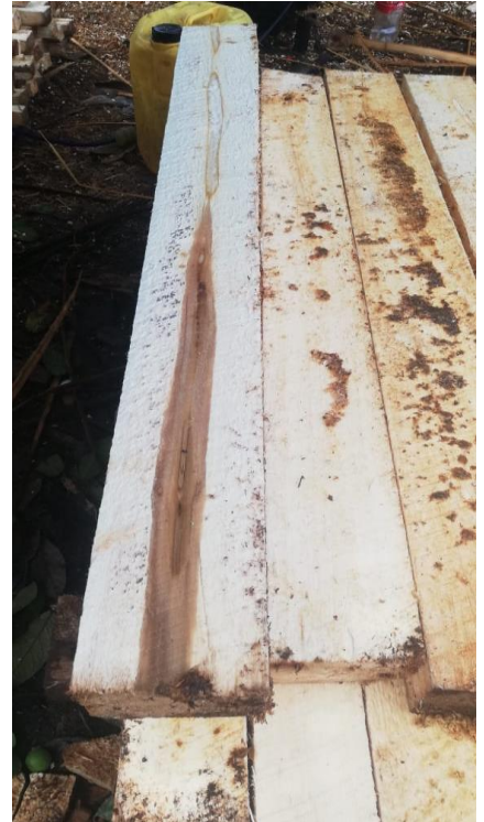
Anexo 9. Presencia de rajaduras de las piezas
