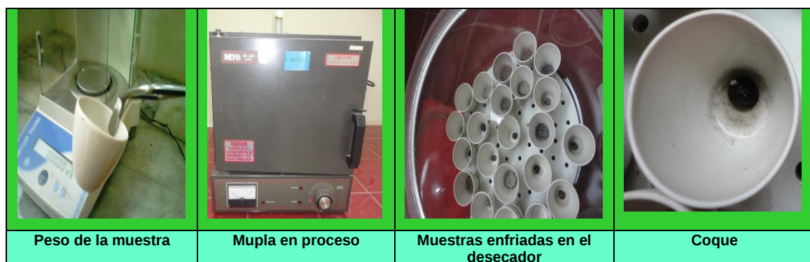
Foto 3.4. Proceso para la obtención de material volátil en biomasa residual de maíz duro
