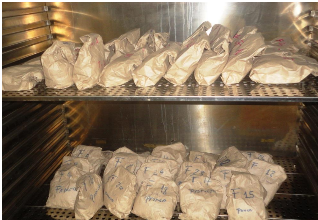
Foto 9. Muestras de Biomasa de maíz en estufa para determinar la humedad
