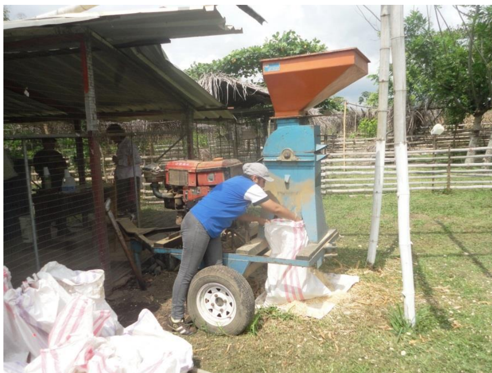
Foto 6. Molienda de la biomasa de maíz duro
