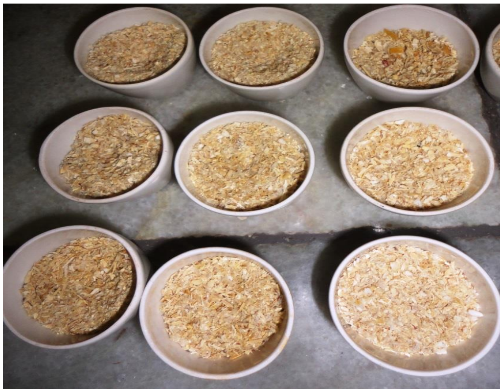
Foto 10. Muestra de biomasa de maíz pesadas en crisoles de porcelana
