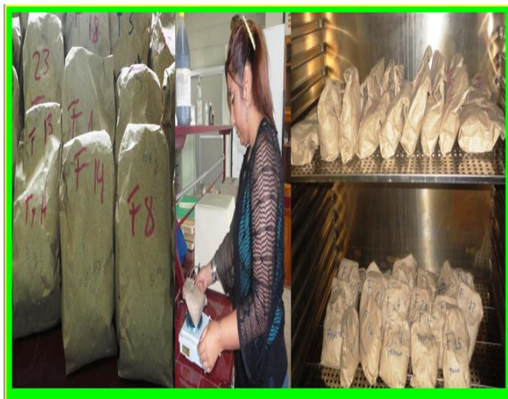
Foto 3.2. Proceso para la obtención de humedad en biomasa residual de maíz duro
