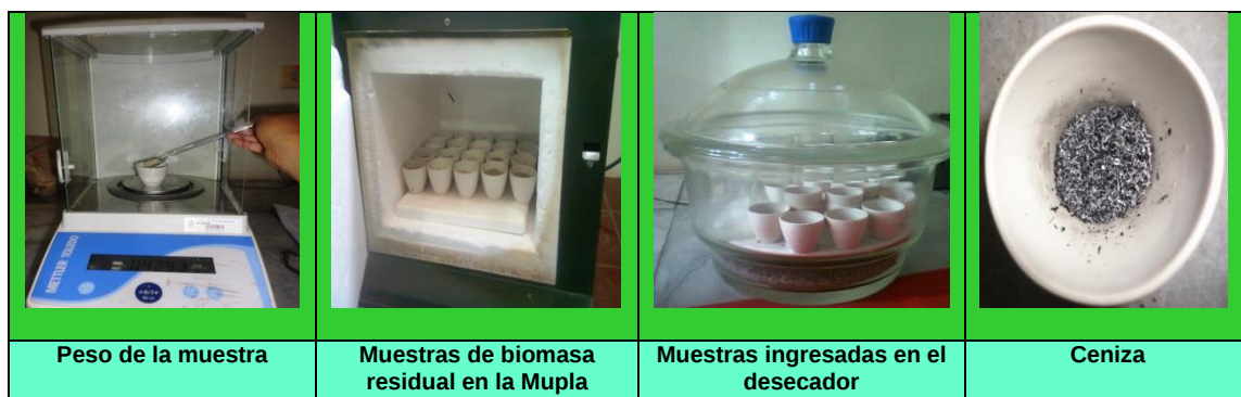
Foto 3.3. Proceso para la obtención de ceniza en biomasa residual de maíz duro
