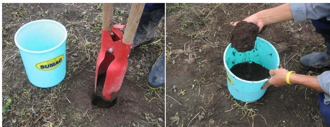
Figura 3.3. Toma de muestras de suelos
