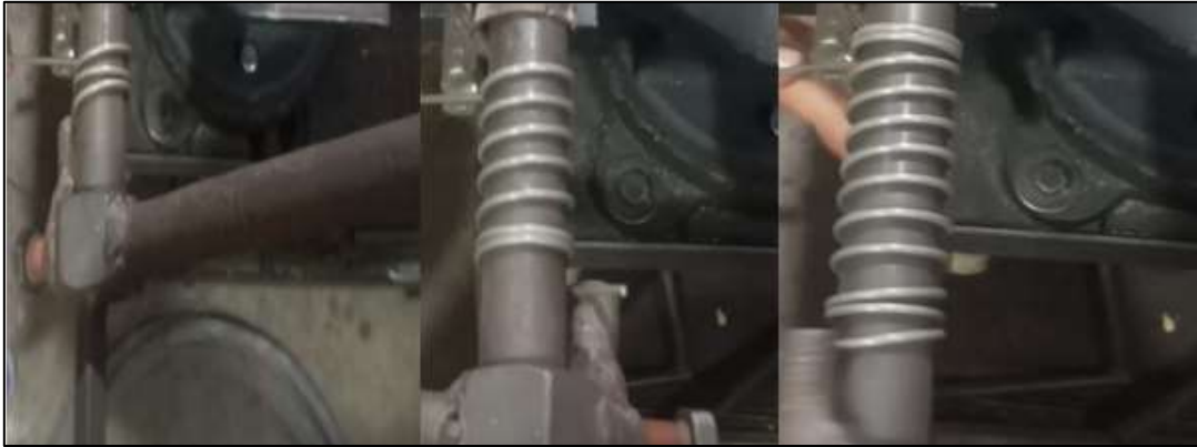
Figura 33. Proceso de fabricación de Resorte.
