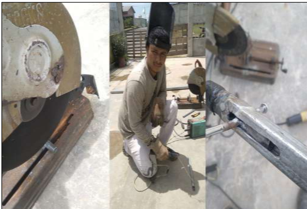
Figura 37. Proceso de fabricación de punta penetradora.
