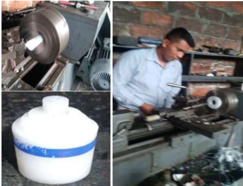
Figura 32. Refrentado de piezas base y selector.
