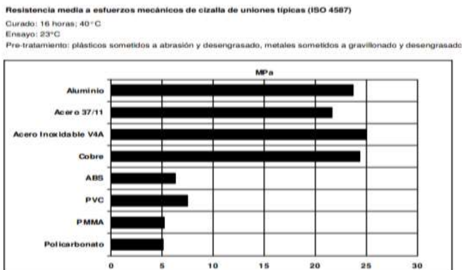
Figura 6. Propiedades típicas de pegamento epóxico.
