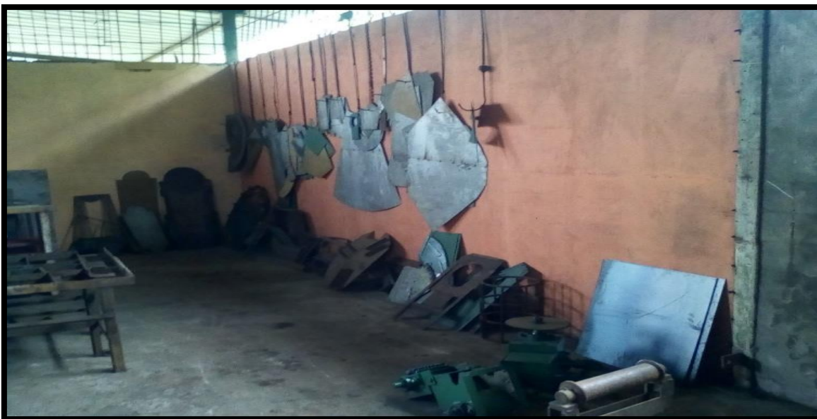
Anexo 19: Moldes de las piezas para la fabricación de las maquinarias agrícolas.
