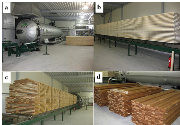
Figura 3. Planta de Thermo Treatment (a), madera a ser tratada (b), madera entrando al autoclave de tratamiento (c), y madera tratada (d) (WTT 2012).
