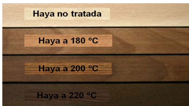
Figura 38. Muestras de madera de haya antes y después de tratamientos a diferentes temperaturas (Modificado de Windeisen et al. , 2007).
