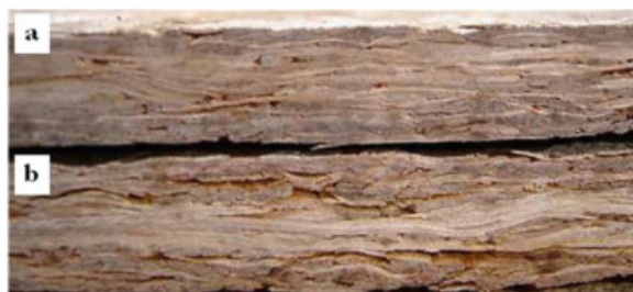
Figura 48. Perfil de espesor después de 8 meses de exposición al clima de tableros OSB tratados a 220 °C por 20 minutos en una prensa (a), y de tableros no tratados con grietas y cavidades (b) (Del Menezzi et al. , 2008).
