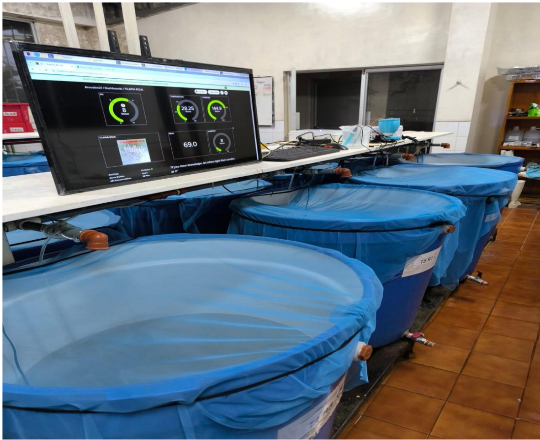
Figura 17 Sistema automatizado de alimentación basado en características físicas de los peces
