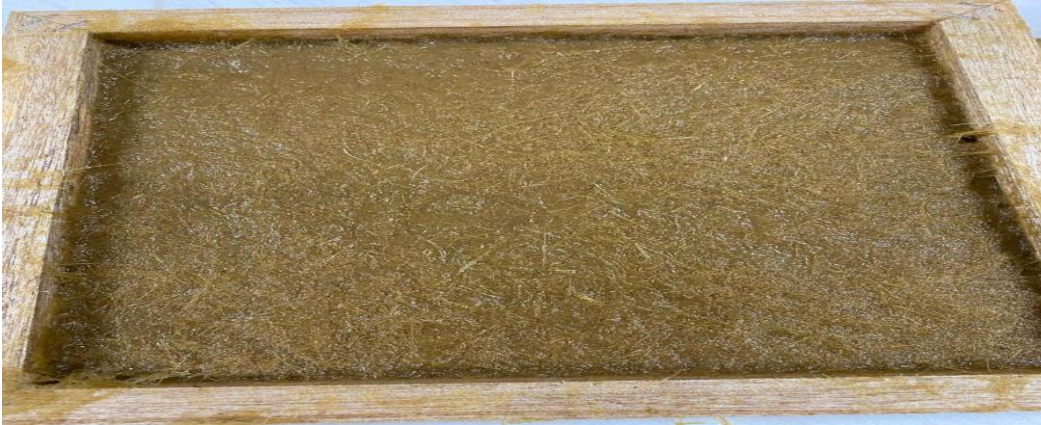
Anexo 66: Secado de la hoja de cartón a partir de hojas obtenida por el método de Wise
