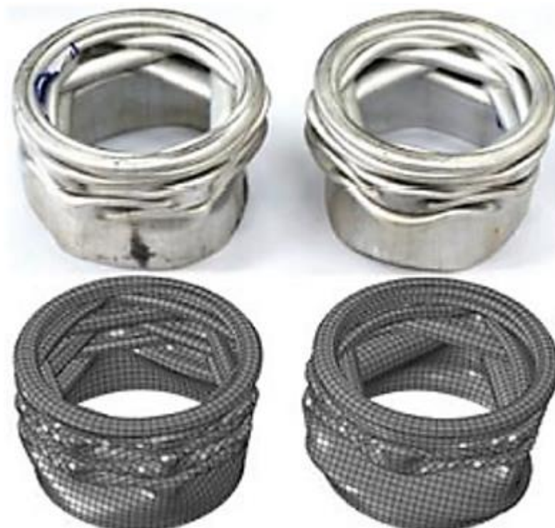
Gráfico 10. Comparación de modelos físicos y de elementos finitos 2D para tubo de aluminio.
