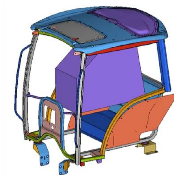
Gráfico 8. Modelo CAD de la estructura de protección FOPS del tractor agrícola.
