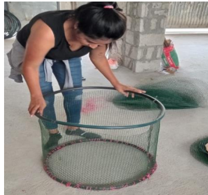
Uniendo la malla con la circunferencia de manguera.
