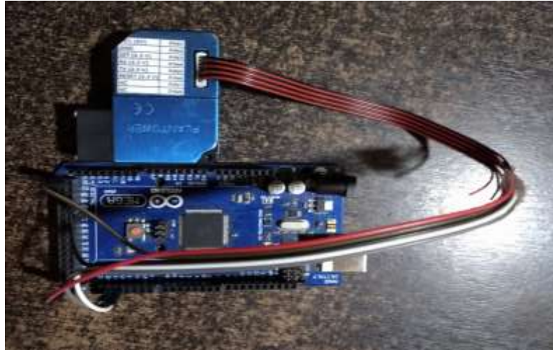
Figura 18 Conexión del sensor PMS3003 con el arduino
