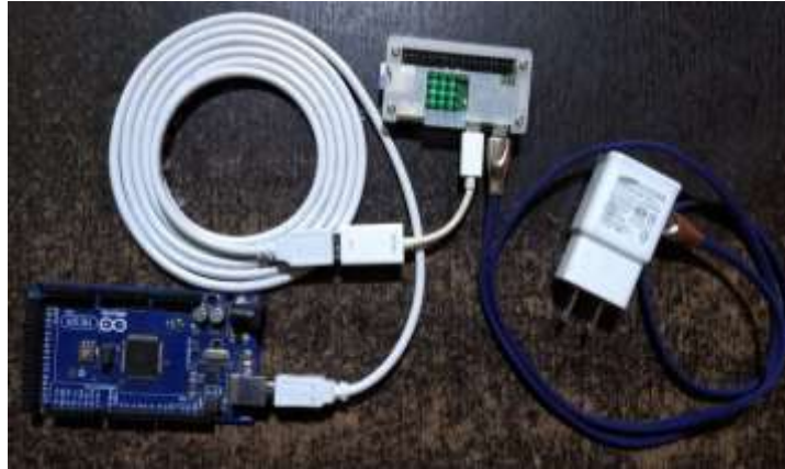
Anexo 4 Conexión de arduino con la Raspberry Pi
