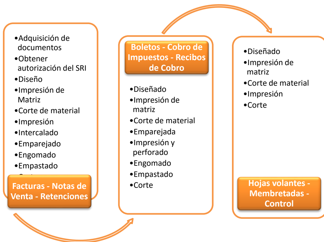
Figura 2. Diagrama de flujo de proceso en la elaboración de los productos de la imprenta La Maná 2010.
