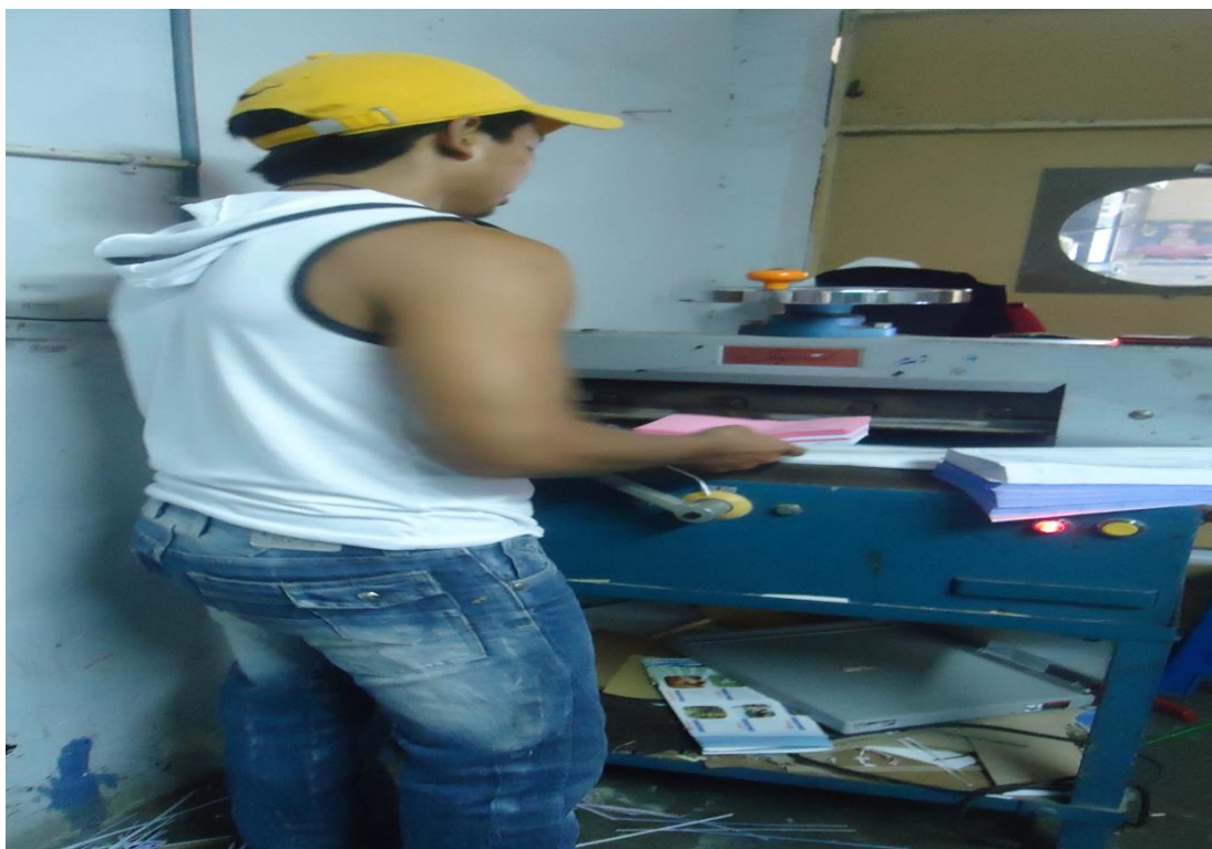
Figura 4. La máquina guillotina se utiliza para el corte del material de la imprenta La Maná 2010
