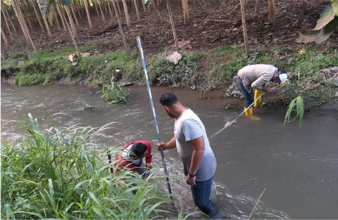
**Fotografía 1.** Aforo en la sección aguas arriba
