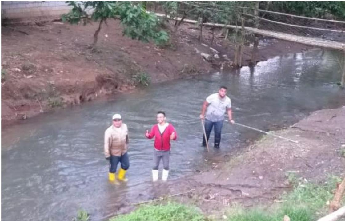
**Fotografía 6.** Realización de aforo en el tramo 2
