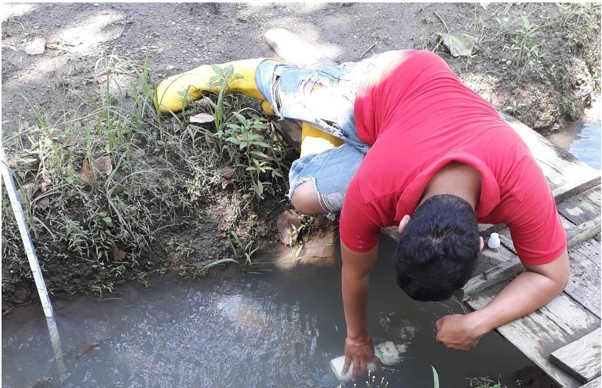
**Fotografía 2.** Toma de muestra para análisis de DBO, descarga 2
