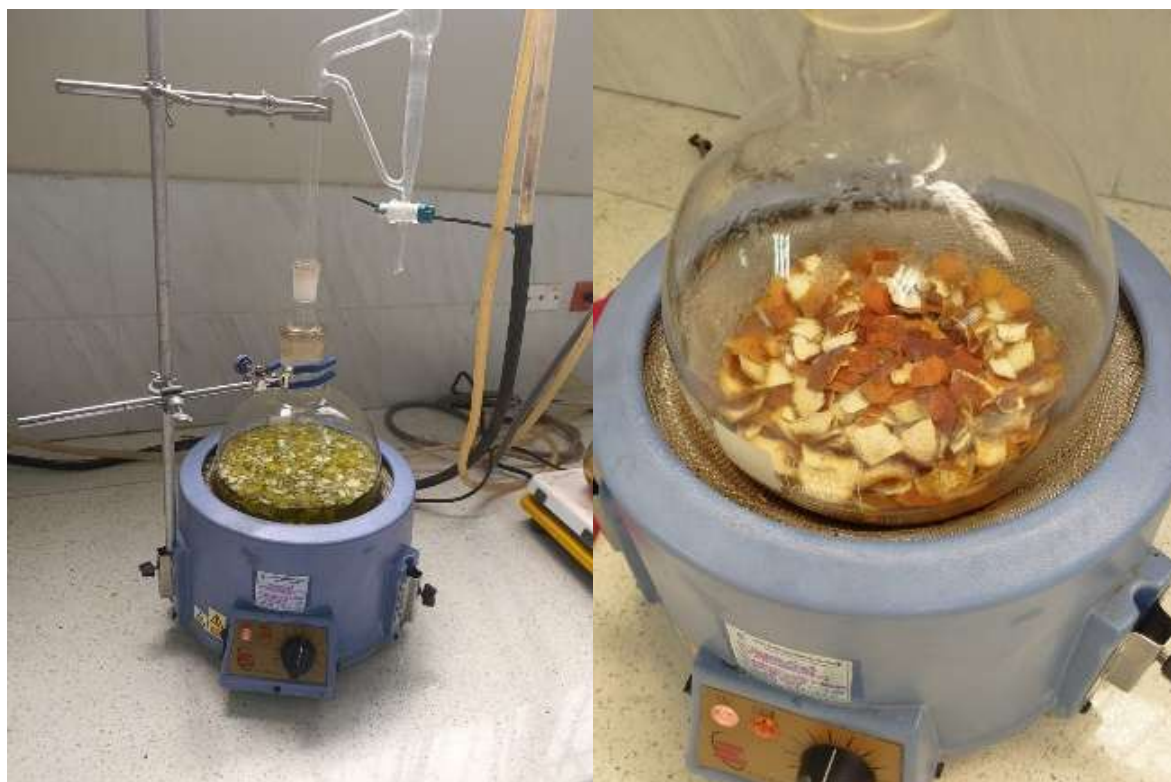
Anexo 7. Destilación por arrastre de vapor con una trampa Clevenger para obtener el aceite esencial
