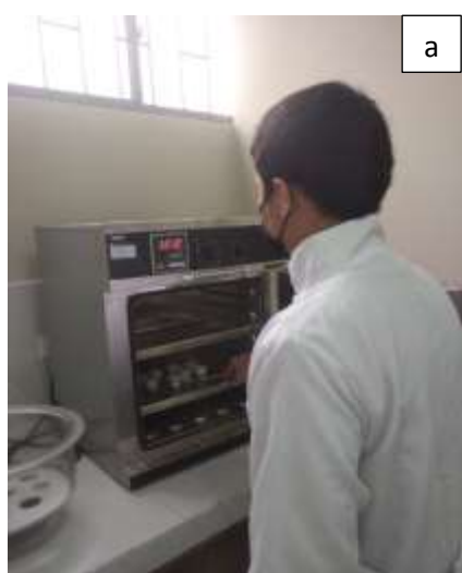
Anexos 11. Colocando los crisoles en estufa (a,b) sacado de crisoles a desecador (c).
