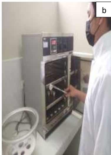
Anexos 11. Colocando los crisoles en estufa (a,b) sacado de crisoles a desecador (c).
