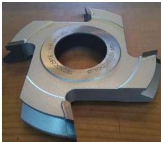
Figura 36. Fresa de tipo plato de cuchillas para uñeros biselados en madera.
