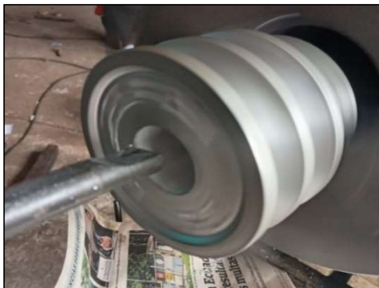
Figura 90. Desbaste de canal de polea.
