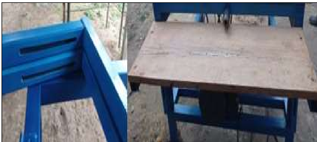
Figura 91. Fabricación de soportes y colocación de tablero para la escopleadora.
