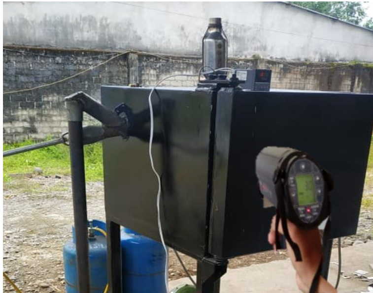
Grafico 37 Medición de temperatura al Horno incinerador
