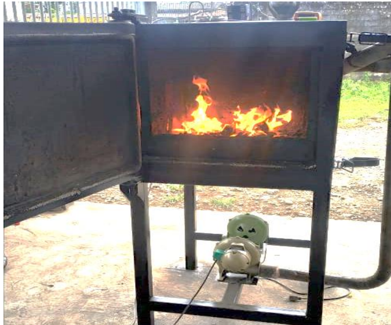
Grafico 39 Horno incinerador en funcionamiento
