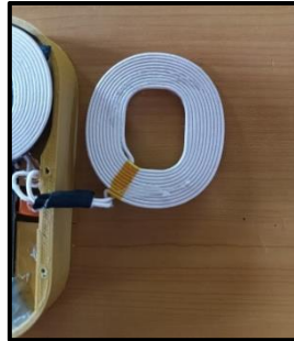
Ilustración 16: Transmisor de carga inductiva Fuente: Investigador
