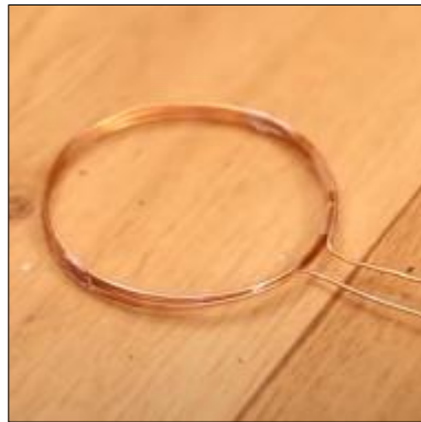
Ilustración 15: Cable de cobre esmaltado de 33 AWG
