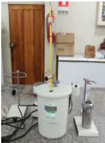
Foto 13.- Equipo para determinar el contenido de energía
