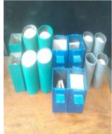
Foto 3.- Moldes con alturas de 10 y 15 cm
