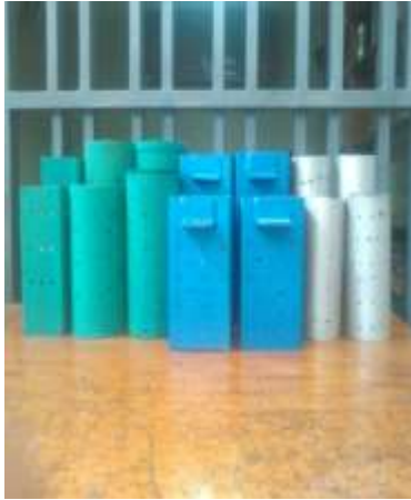
Foto 1.- Moldes con alturas de 10 y 15 cm
