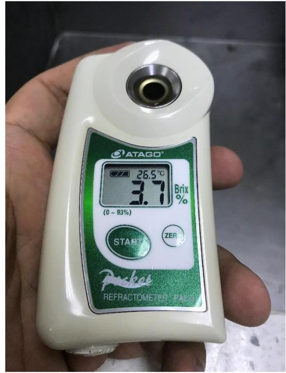
Refractómetro usado para lectura de los grados brix (°brix).
