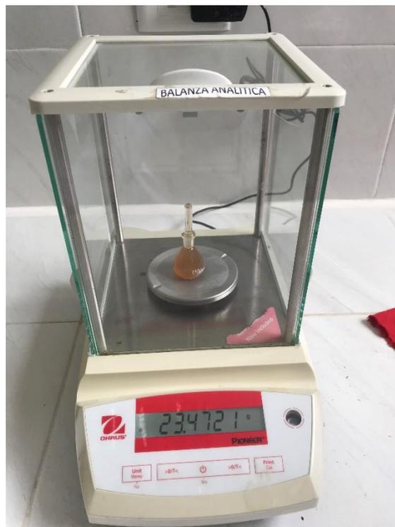
Calculo de la densidad por el método del picnómetro.
