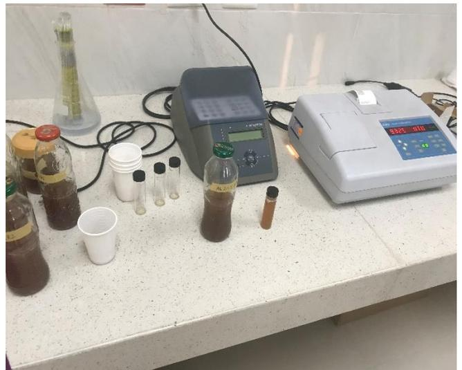
Lectura de la turbidez de la bebida fermentada con el Turbidímetro.
