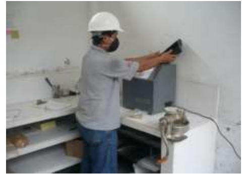
MEDICION DE HUMEDAD DE LA SOYA TOSTADA
