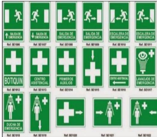
Ilustración 13 Señalización de salvamento y socorro
