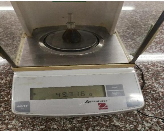
Picnómetro con muestra para calcular la densidad
