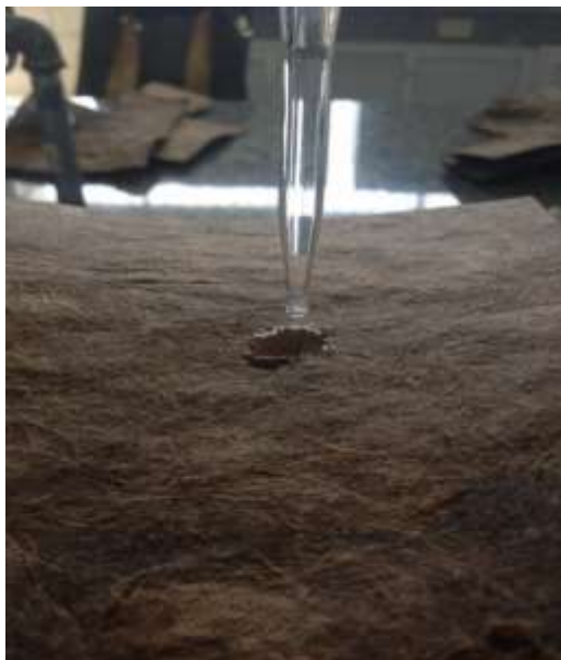
Determinación de tiempo de absorción de agua por el método empleado en papeles porosos
