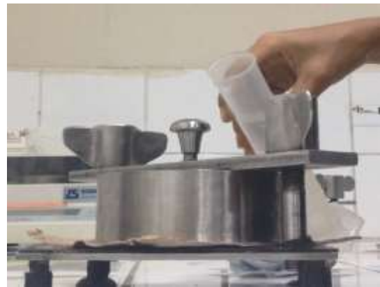
Adición de agua destilada
