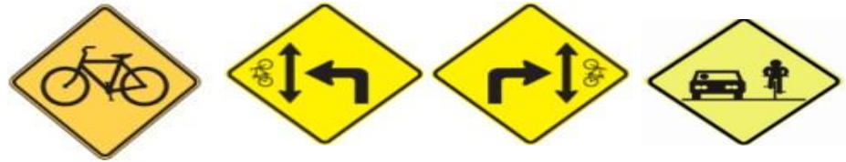
Figura 44. Ciclistas, Cruce de Bicicletas y Vía Compartida. Fuente: Instituto Ecuatoriano de Normalización, 2013
