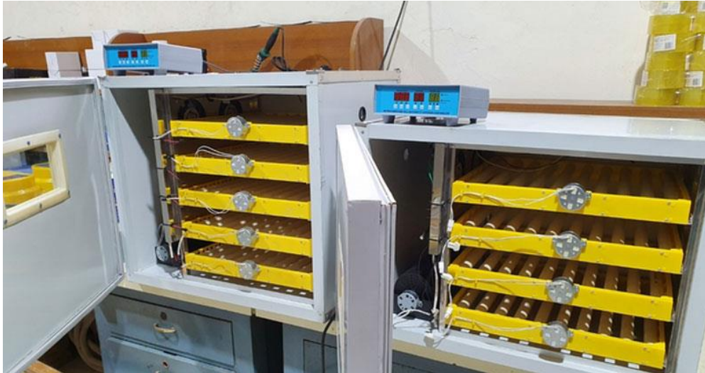
Figura 2. Incubadora vertical de uso industrial para grandes grupos de huevos [6].
