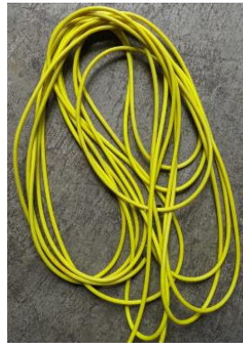
Figura 23. Cable calefactor utilizado en la incubadora.
