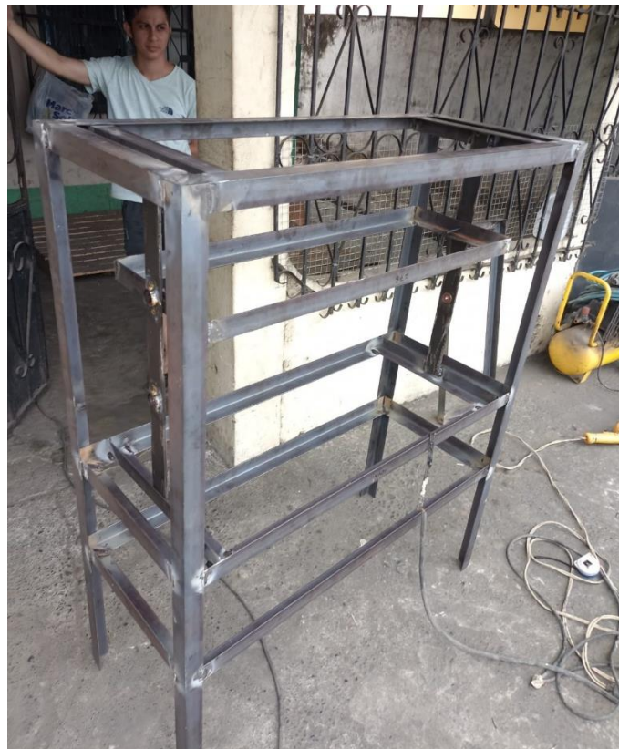
Anexo 16. Estructura en perfil tipo ángulo terminada para incubadora.
