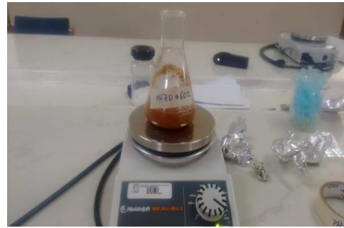
Extracción del sustrato digerido
