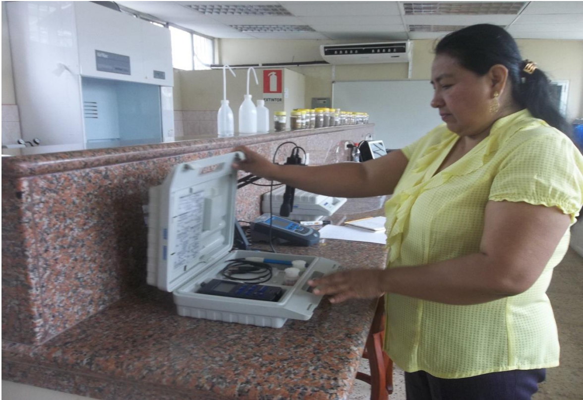
FIGURA 24. LECTURA DE pH Y TEMPERATURA EN ALÍCUOTA DE AGUAS RESIDUALES PROVENIENTES DEL CAMAL MUNICIPAL DE QUEVEDO
