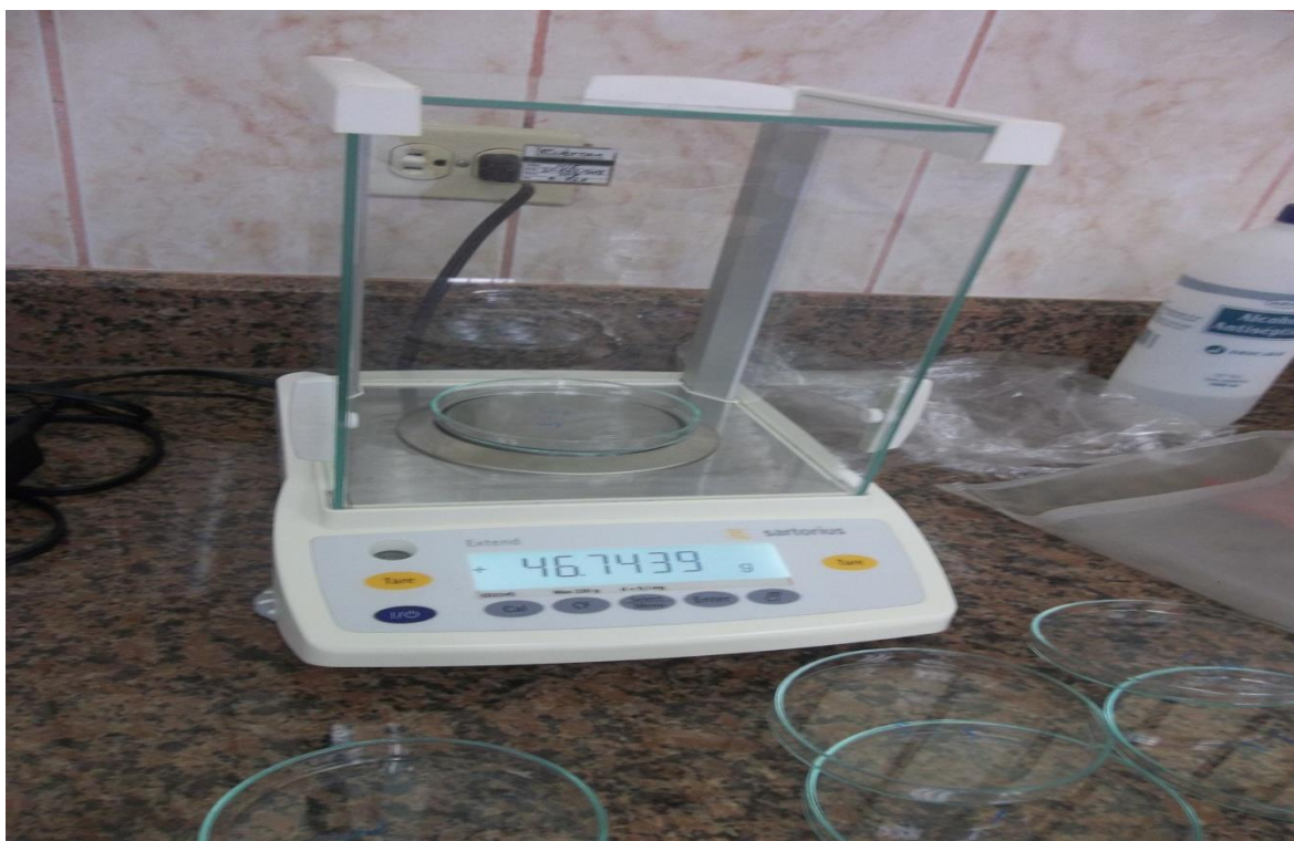
FIGURA 26. PESO DE CAJA PETRI (g) MEDICIÓN DE 25 ml EN ALÍCUOTA DE AGUAS RESIDUALES
