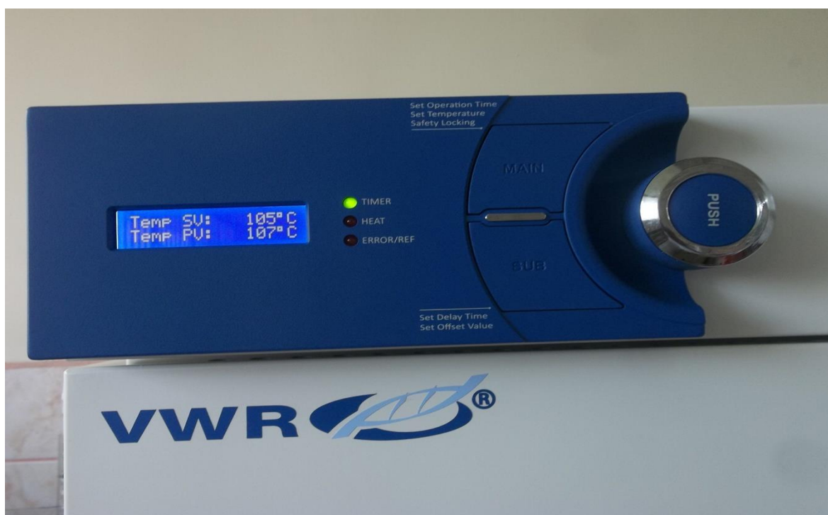
FIGURA 27. PROCESO VOLATILIZACIÓN O EVAPORACIÓN EN ESTUFA DE AIRE FORZADO 105° C PARA OBTENCIÓN SÓLIDOS TOTALES
