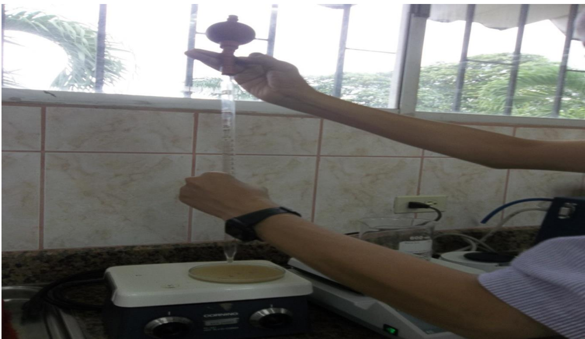
FIGURA 25. MEDICIÓN DE 25 ml EN ALÍCUOTA DE AGUAS RESIDUALES
