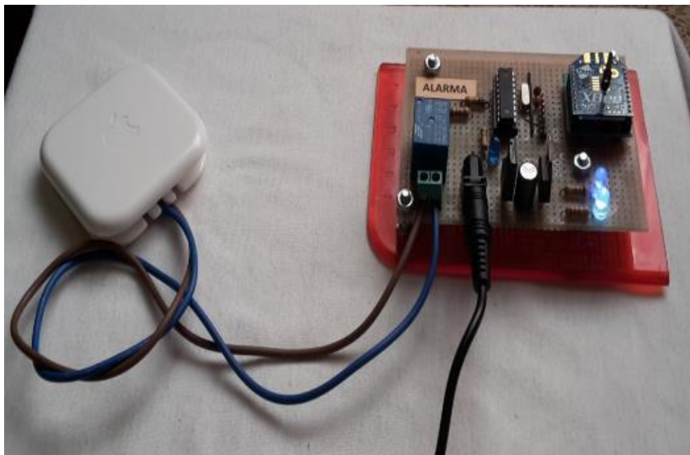
Figura: Módulo Receptor Alarma en Funcionamiento
