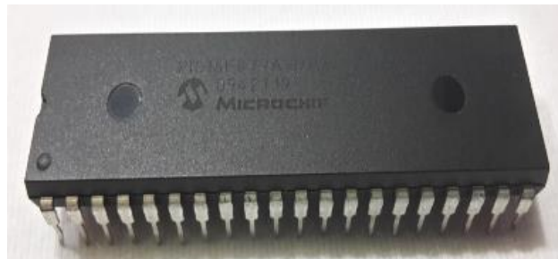
Figura 4.4: El microcontrolador 16F877A
