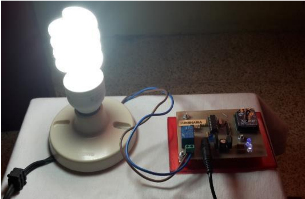
Figura: Módulo Receptor Luminaria en Funcionamiento
