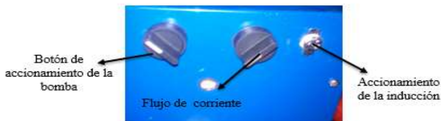
Gráfico 36: Cajetín de interruptores
