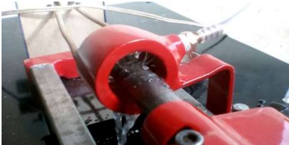
Gráfico 42: Procesos de enfriamiento del eje una vez alcanzada su temperatura de temple
