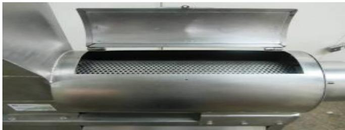
Figura 3 Máquina despulpadora horizontal.
