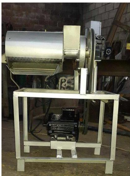
**Figura:24 Equipo despulpador de chontilla**
