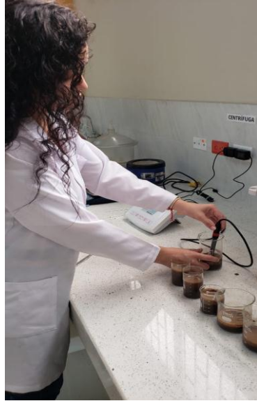
Proceso de medición de pH en muestras de suelo de las especies forestales, Guazuma ulmifolia , Albizia guachapele , Eugenia pustulescens y Cecropia peltata en el bosque secundario “Noé Morán”.
