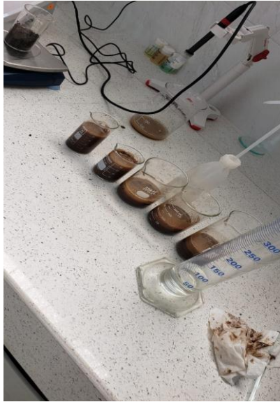
Proceso de medición de pH en muestras de suelo de las especies forestales, Guazuma ulmifolia , Albizia guachapele , Eugenia pustulescens y Cecropia peltata en el bosque secundario “Noé Morán”.
