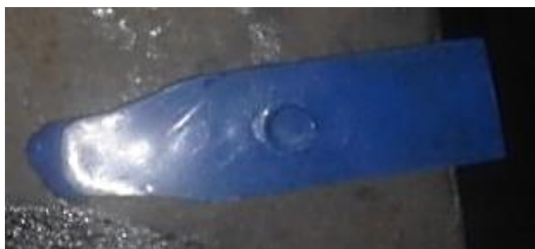
Figura. 34. Probeta de PEBD incompleta.
