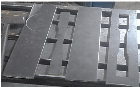
Figura. 19. Placas cortadas por el chorro de agua.
