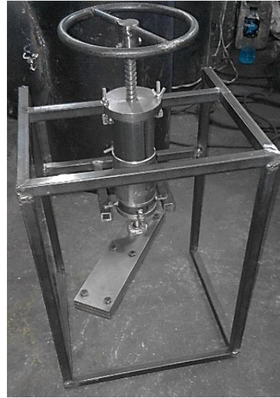
Anexo 7. Ensamblaje de la inyectora más estructura y molde.
