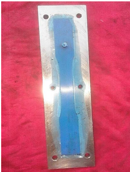
Anexo 6. Molde inyectado con la probeta.
