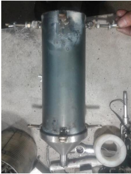
Anexo 5. Cilindro de inyección con sus soportes soldados.
