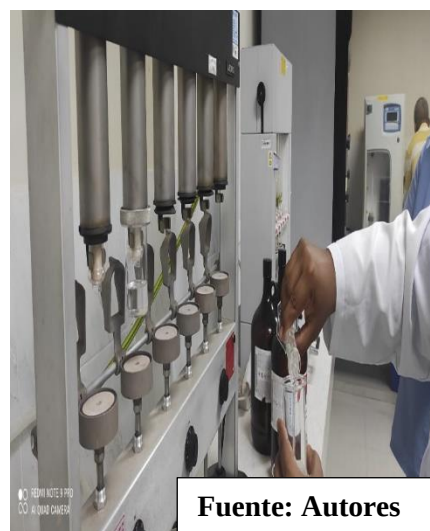
Fig.17 Adición de éter de petróleo en vaso Beacker
