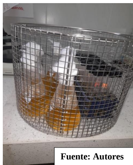
Fig.37 Ingreso de las muestras a la estufa por 48h.
