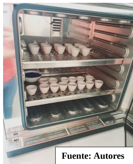
Fig.21 Ingreso de la muestra en la estufa
