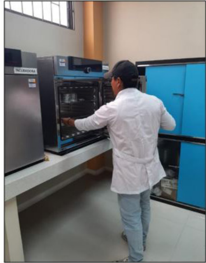
Anexo 5. Obtención del peso de las muestras y posterior colocación en la estufa.
