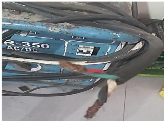
**Figura 20.** Soldadora eléctrica LMEC-SLD-02 sin enchufe.
