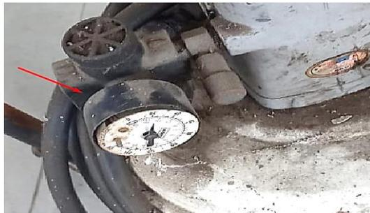
**Figura 28.** Manómetro dañado de la engrasadora neumática LMEC-ENG-02.
