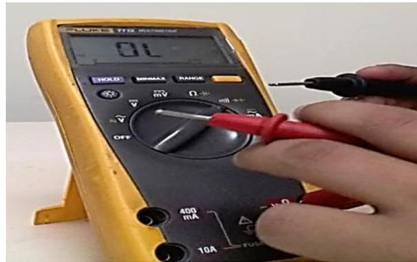
**Figura 40.** Prueba de funcionamiento de multímetro.
