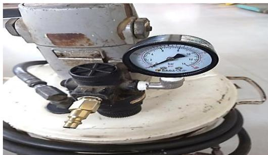
**Figura 29.** Instalación de un nuevo manómetro para la engrasadora LMEC-ENG-02.
