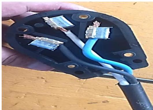
**Figura 23.** Instalación de un enchufe industrial al compresor de tubo vertical.
