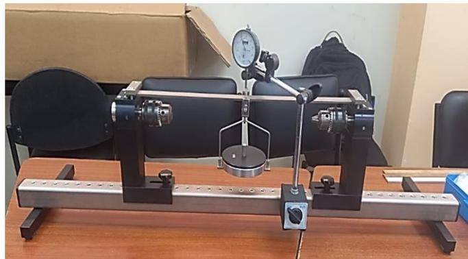
**Figura 60.** Prueba de funcionamiento del instrumento deformador de barras.
