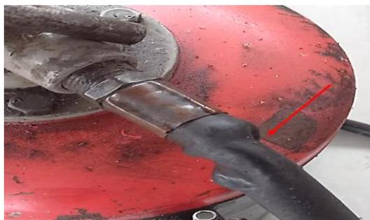
**Figura 30.** Parte de la manguera de la engrasadora manual dañada.
