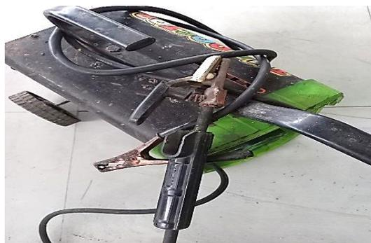
**Figura 17.** Portaelectrodo dañado de la soldadora eléctrica LMEC-SLD-01.
