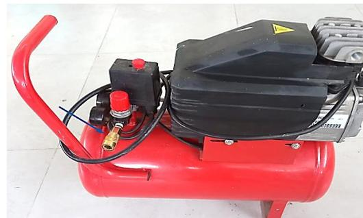
**Figura 27.** Instalación de acople de aire para el compresor LMEC-CMP-02.
