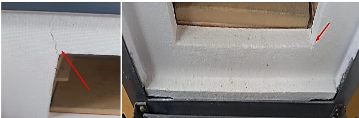
**Figura 58.** Fisuras en el material refractario de la mufla.
