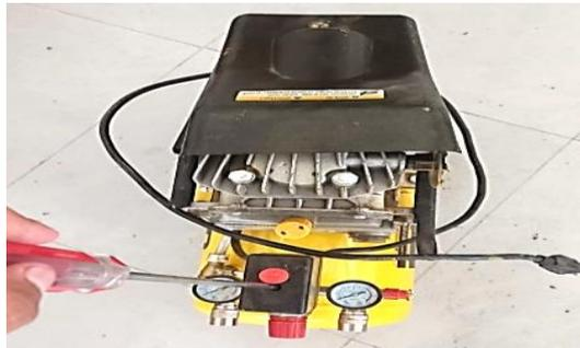
**Figura 26.** Ajuste del presostato mediante un tornillo.
