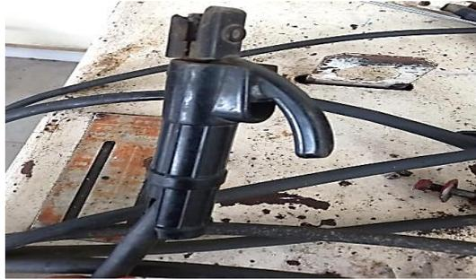
**Figura 19.** Portaelectrodo dañado de la soldadora eléctrica LMEC-SLD-02.
