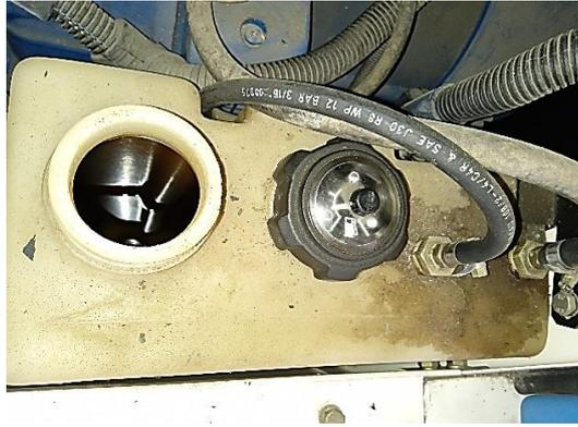
**Figura 36.** Falta de diésel en el tanque de combustible.
