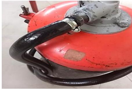
**Figura 31.** Reparación de la parte de la manguera dañada de la engrasadora manual.
