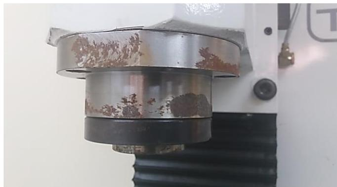
**Figura 52.** Corrosión en el cabezal.
