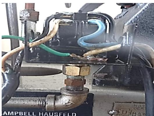
**Figura 24.** Limpieza a los contactos del presostato.
