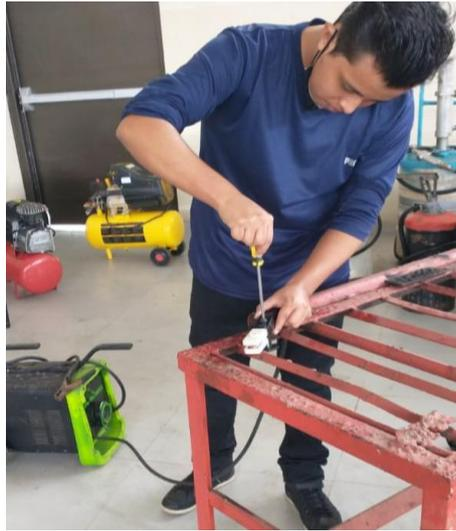
**Anexo 2.** Prueba de funcionamiento de las engrasadoras neumáticas.
