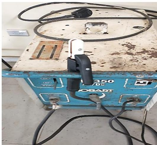
**Figura 21.** Reemplazo de portaelectrodo y enchufe a la soldadora eléctrica LMEC-SLD-02
