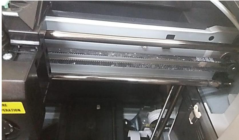
**Figura 48.** Suciedad en las bandas de la boquilla.
