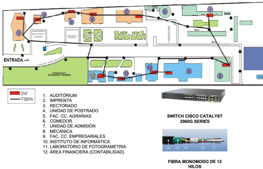
Figura 23: Anillo de Fibra Óptica instalado
