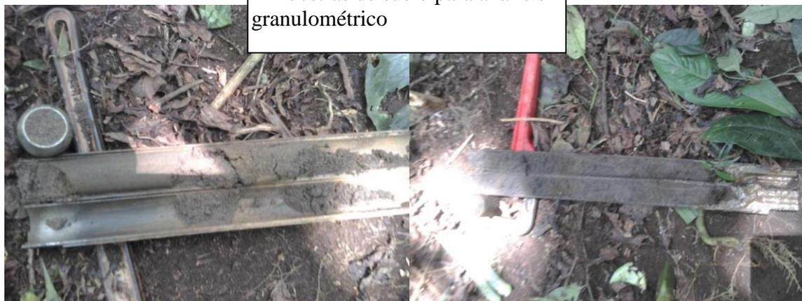
Ejecución del ensayo SPT, equipo de perforación.
