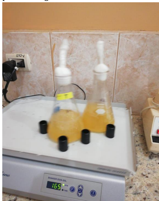
Anexo 3. Mezclador orbital digital ELMI DOS-20L de 20 mm de amplitud con plataforma grande
