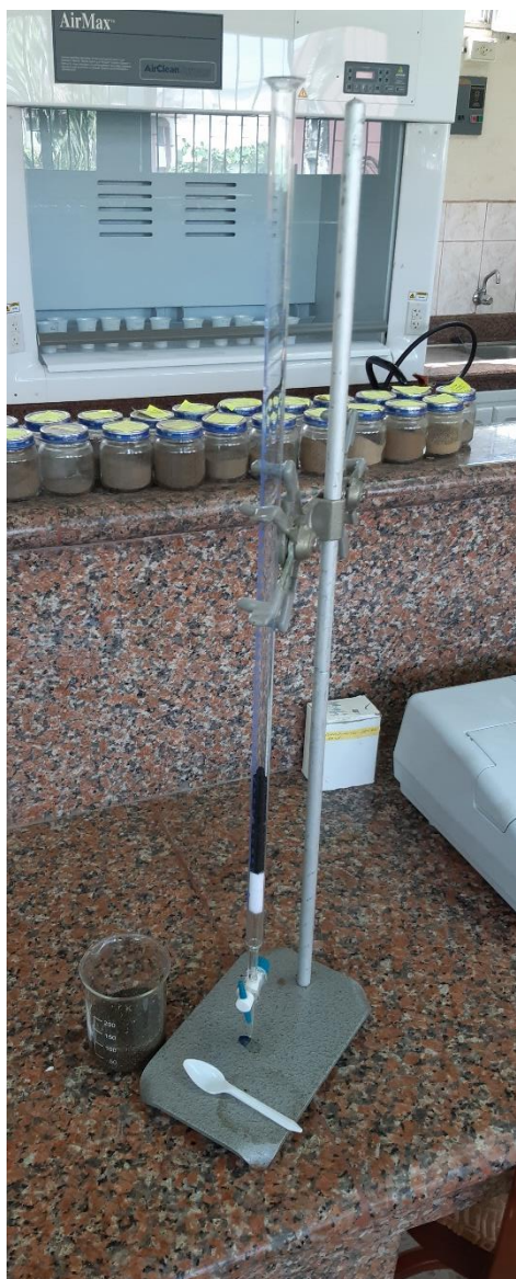
Foto 13. Filtro de carbón activado
