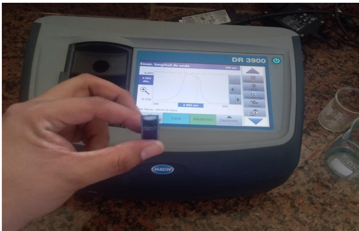
Foto 11. Prueba de absorbancia de azul de metileno en espectrofotómetro UV-Vis.
