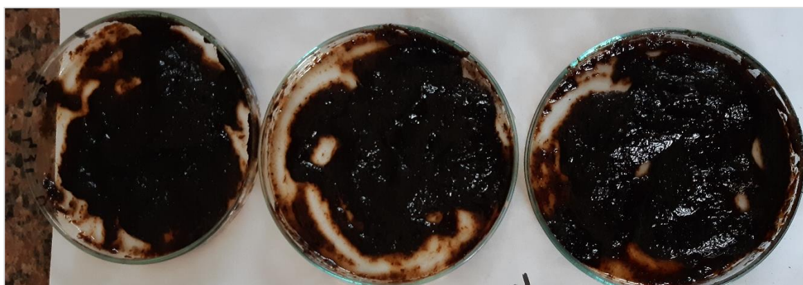
Foto 8. Impregnación de la materia prima con ácido fosfórico al 85% de concentración.
