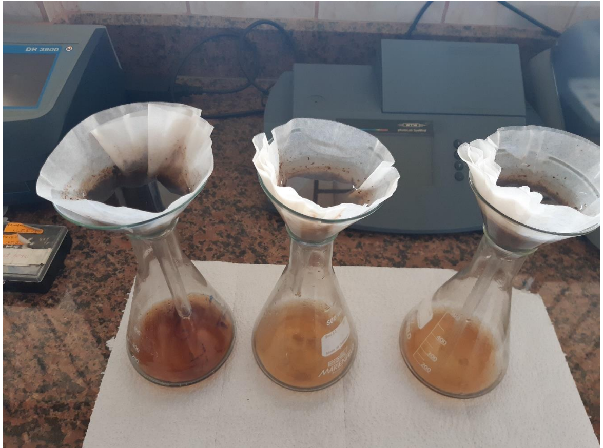
Foto 9. Lavado de la muestra impregnada con agente activante después de 24 horas y regulando a pH neutro.
